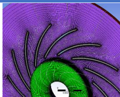
Рисунок 2 – Общий вид рабочего колеса и диффузора, разбитый на сетку конечных элементов
