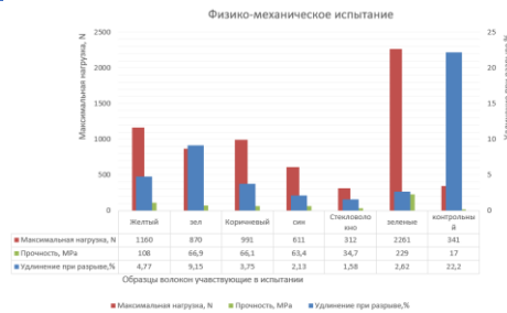
Рисунок 1 – Анализ физико-механических характеристик полимерной матрицы с применением разных армирующих материалов.
